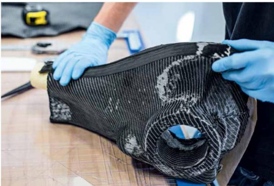
Protótipo de um conjunto da estrutura do suporte da roda combinado para carros, feitos com plástico reforçado com fibra de carbono (PRFC).
