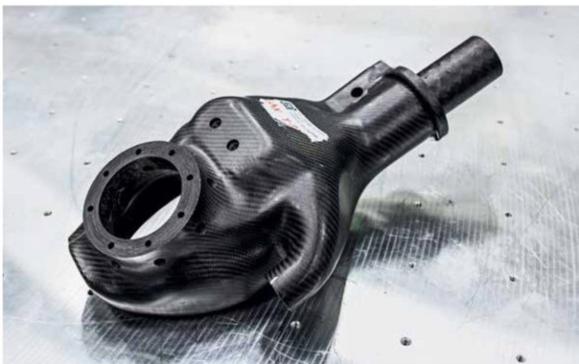
Amostra inicial de um módulo de suspensão da estrutura de suporte da roda produzido com PRFC (Plástico Reforçado com Fibra de Carbono) – ainda há um longo caminho a percorrer antes que esteja pronto para a produção em série.
