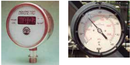
Fig.6 – Uso do manômetro padrão para calibração
