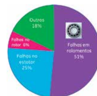
Fig.1 – Falhas típicas em motores AC até 4
