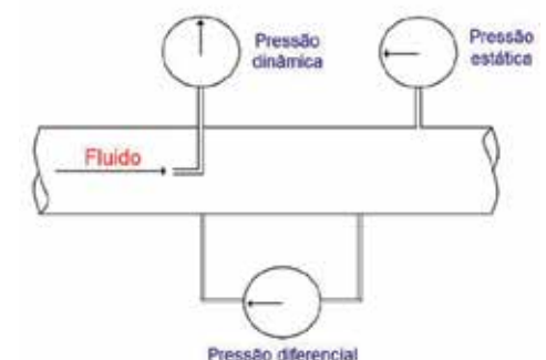
Fig. 2 – Medição de pressão
